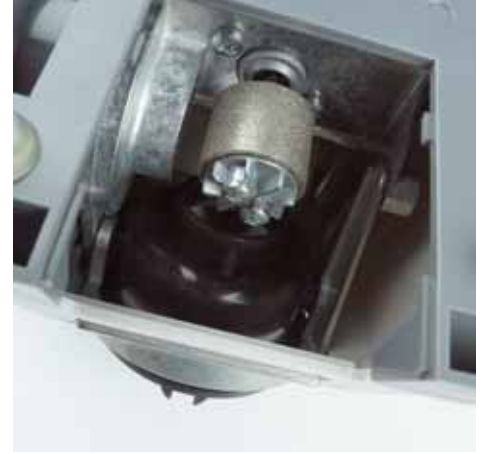
Der feine, diamantbestückte Schleifring kann für größere Bohrerdurchmesser gegen eine gröbere Körnung ausgetauscht werden (ca. 50 Euro)
