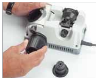
Nach Entfernen des Absaugadapters ist die Öffnung für den Ausspitzvorgang frei
