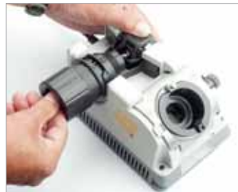
Für den korrekten Schliff wird der Bohrer im Spannfutter genau fixiert
