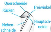
Es ist wichtig, zu verstehen, dass ein jeder Bohrer eine Querschneide, eine Hauptschneide, einen Rücken, einen Freiwinkel und eine Nebenschneide besitzt. (Die Nebenschneide wird für die Ausrichtung des Bohrers wichtig sein.)
